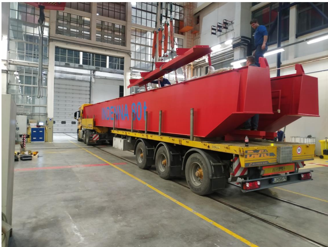
Slika 10: Prihod nove opreme v objekt. (Lasten vir)
