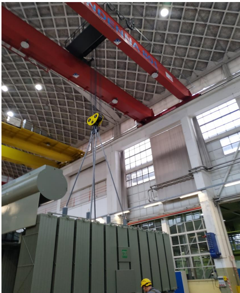
Slika 16: Obremenitev dvigala med pregledom. (Lasten vir)
