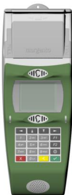
Slika 42 - Mobilni terminal za kontrolo in prodajo vozovnic (Vir:Podjetje Ultra) 2009
