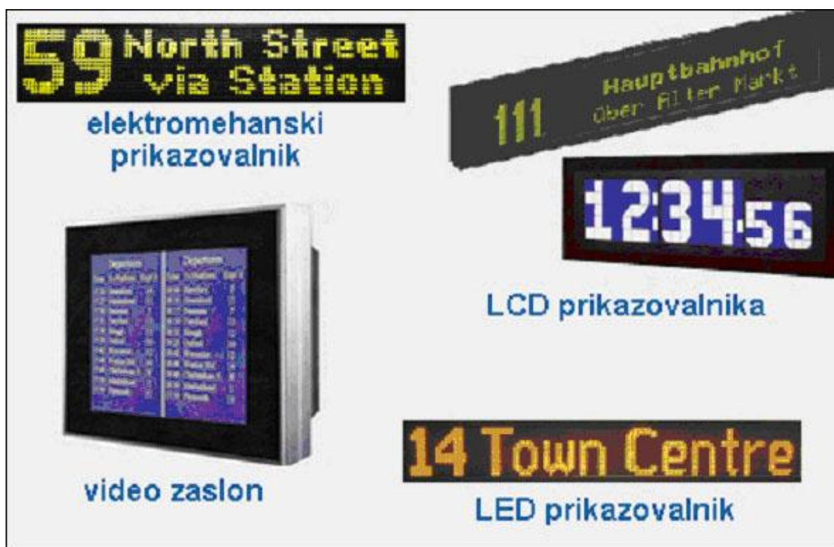
Slika 29 - Različne tehnologije dinamičnih prikazovalnikov informacij (Vir: LPP) 2009
