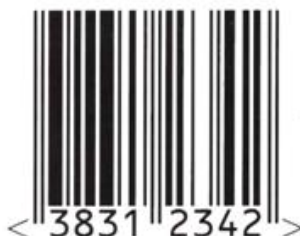
Slika 7: EAN 8 simbol (Vir: http://www.leoss.si , dostopno 17. 5. 2010)
