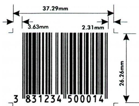
Slika 6: EAN 13 simbol (Vir: http://www.leoss.si , dostopno 17. 5. 2010)
