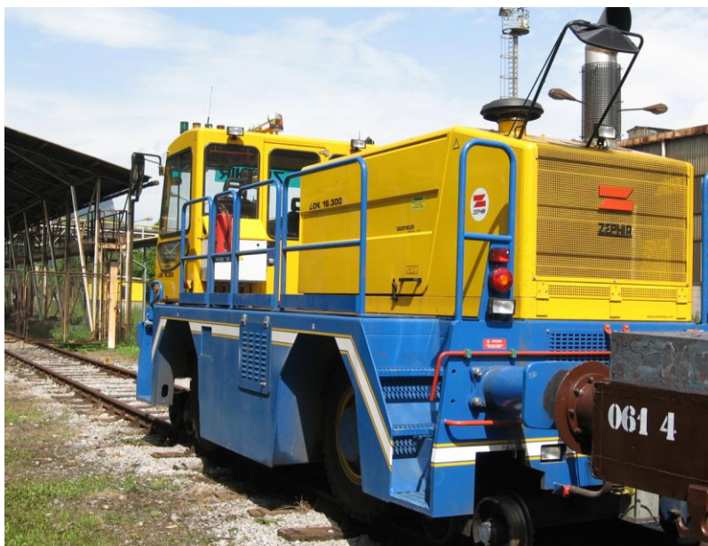
Slika 9: Premikalno dvopotno vozilo – Zephir 16.300 Vir: Damjana Nučič – maj 2008
