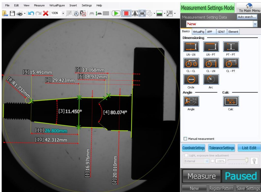
Slika 5: Meritve glavne gredi AM6-motorja s pomočjo digitalnega profil projektorja (Lastni vir)
