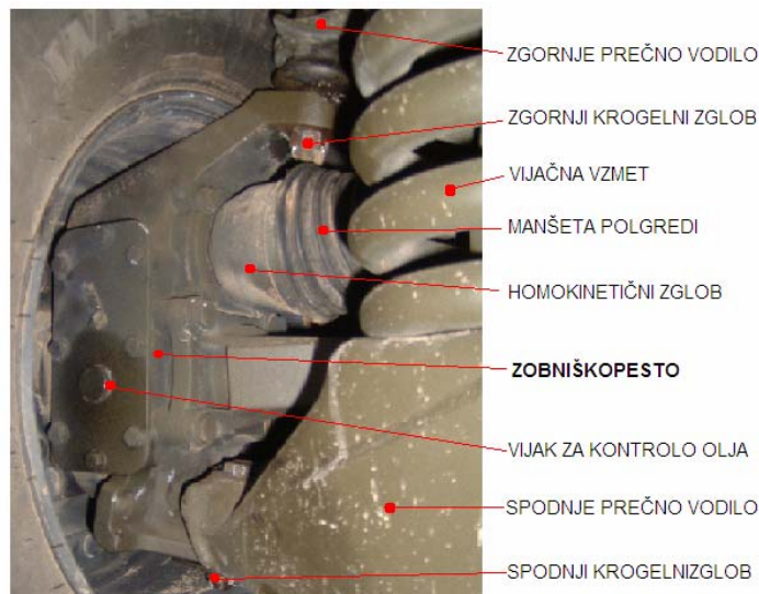
Slika 11: zobniško pesto (vir: lasten posnetek)
