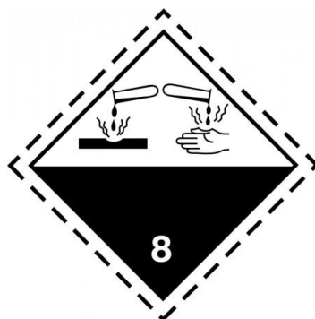
Slika 6: Nalepka nevarnosti za razred 8 (jedke snovi) (Vir: Interni vir LM, Varnostni list, avgust 2016)
