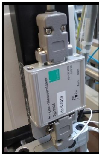
Slika 39: Merilna celica Burster In-Line Messverstärker Type:9235 (Lastni vir)
