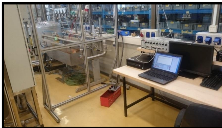
Slika 30: Tlačni preizkus testne proge (Lastni vir)
