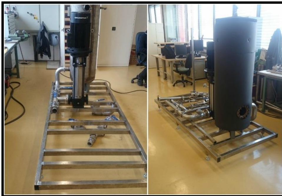
Slika 15: Zalogovnik in 11 kW črpalka na nosilnem delu testne proge (Lastni vir)
