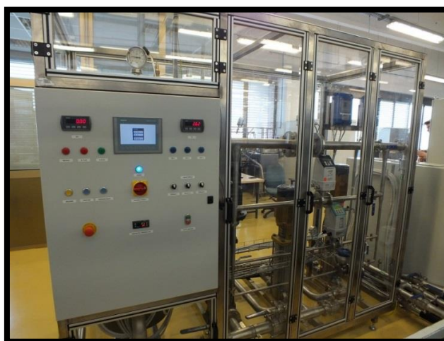
Slika 26: Krmilna elektro omara s testno progo (Lastni vir)
