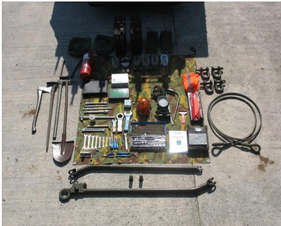
Slika 8: Primer zlaganja opreme za lahko kolesno oklepno vozilo Valuk (Vir: SOP št. 1413, Poveljniški pregled v 10. PEHP)
