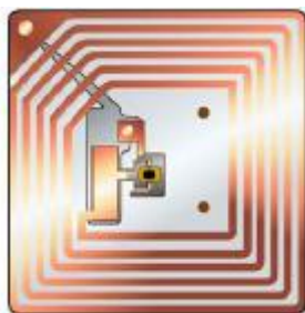
Slika 6: RFID značka (Vir: rikheij.wordpress.com/2008/11/)
