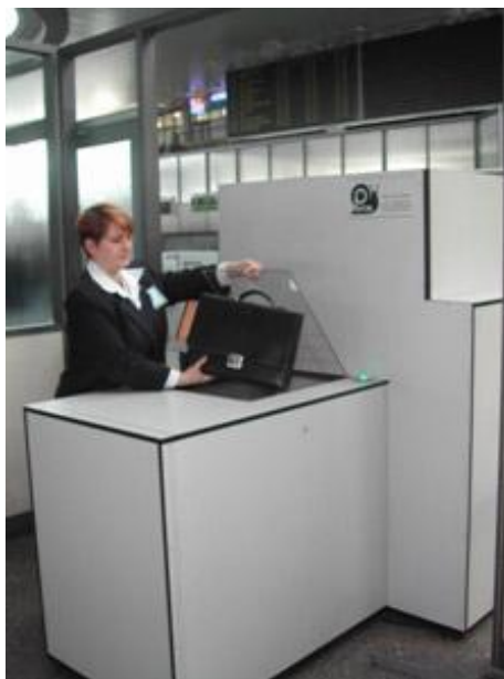
Slika 17: EDS - 5101 Sistem za odkrivanje eksploziva in radioaktivnih snovi (Sant Petersburg, Rusija) (Vir: http://www.ratec-spb.ru/about.html )
