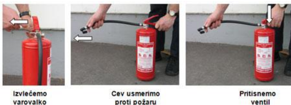
Slika 11: Način aktiviranja gasilnika na prah
