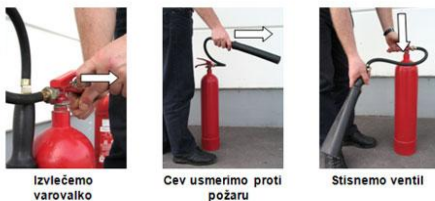
Slika 12: Način aktiviranja gasilnika s polnilom CO 2
