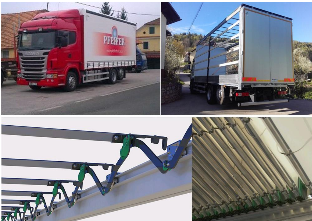
Slika 8: Nadgradnja z bočno zaveso, pomično streho, pomičnimi srednjimi stebri ter ALU vrati
