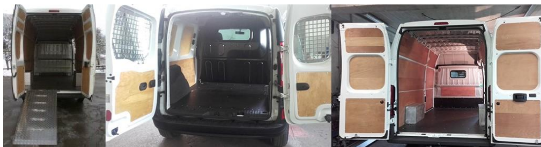
Slika 12: Nadgradnja notranjosti kombija in izdelava ALU nakladne ploščadi
