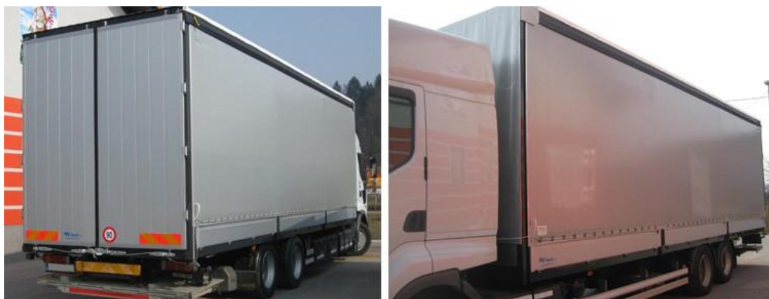
Slika 9: Nadgradnja z bočno zaveso, leva plus desna stran z ALU stranicami, ALU vrati ter z zložljivo nakladalno ploščadjo
