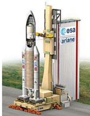
Slika 8: Skica nosilne rakete Ariane in v prerezu eden izmed satelitov sistema Galileo
