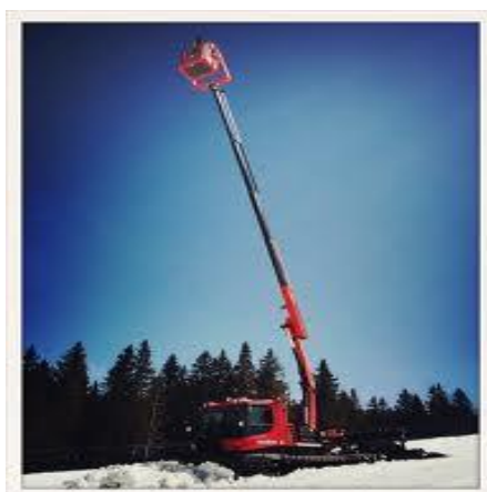
Slika 13: Hidravlično dvigalo z dvižno košaro (Vir: http://domisljije.si/blog/2010/04/13/double-air/ )
