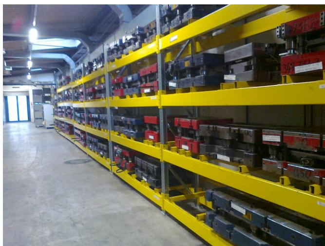
Slika 21: Skladišče velikih orodij (Vir: Domel, d.o.o.)
