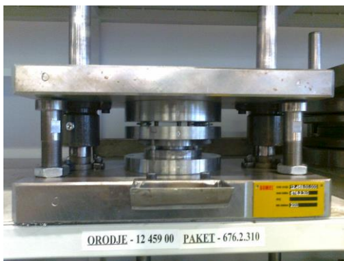
Slika 11: Orodje s podatki na ploščici (Vir: Domel, d.o.o.)
