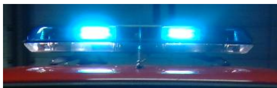
Slika 1: Strešna konzola modre luči, bele luči, rumene luči, sirena in govorna naprava (Osebni arhiv, 2008)
