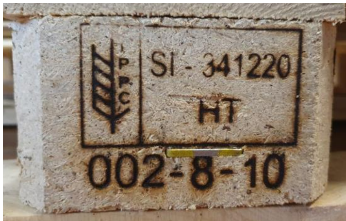
Slika 7: Žig za termično obdelavo palete (Lastni vir)
