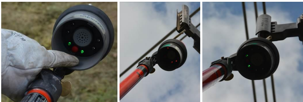
Slika 14: Preizkus breznapetostnega stanja (Lastni vir)
