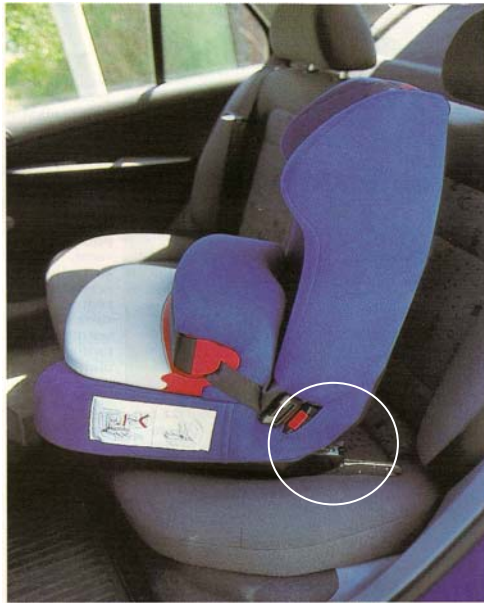
Slika 29: Na sliki je vidna ena od pritrdilnih zank sistema Isofix.
