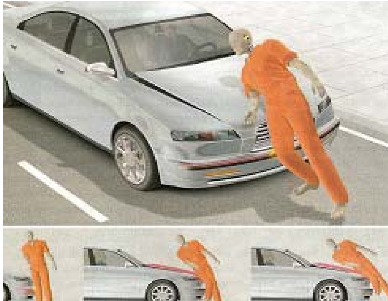
Slika 32: Pri trku s pešcem, se pokrov avtomobila rahlo dvigne.
