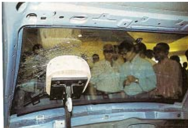
Slika 22: Počeno vetrobransko steklo mora zadržati varnostno blazino in potnike v avtomobilu.
