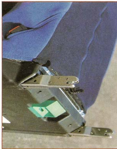
Slika 30: Pritrdilni sistem Isofix.
