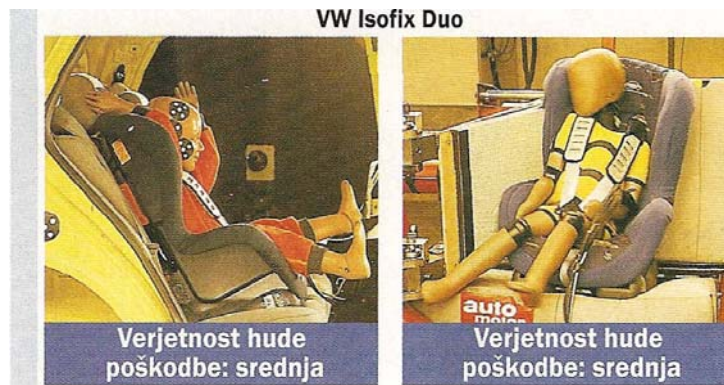
Slika 27: Primer testiranja čelnega trka (leva slika) in bočnega trka (desna slika) z otroškim sedežem, ki jo izdeluje tovarna Volkswagen.
