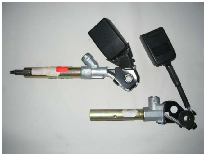
Slika 8: Nesprožen in sprožen zategovalec varnostnega pasu.
