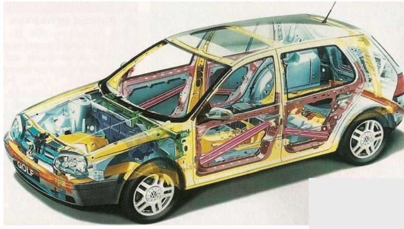
Slika 19: Varnostna kletka vozila Golf. Deli obarvani rumeno so zmečkljivi, deli obarvano rdeče pa togi.
