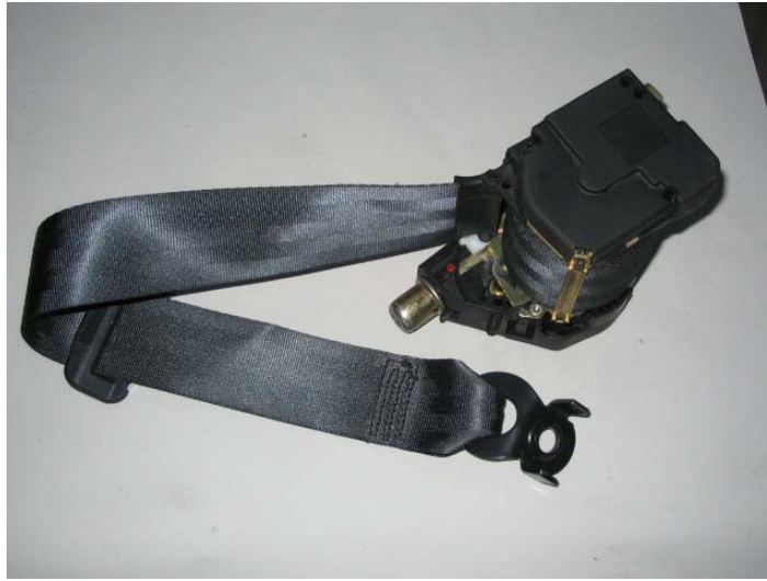
Slika 9: Varnostni pas z zategovalnikom.
