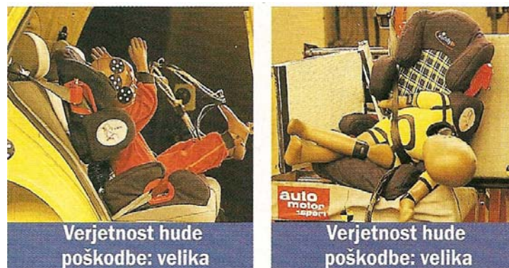
Slika 28: Primer testiranja čelnega trka (leva slika) in bočnega trka (desna slika) z otroškim sedežem, ki jo izdeluje tovarna Kiddy life.
