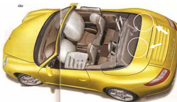
Slika 20: Sprožena varnostna loka vozila Porsche Carrera
