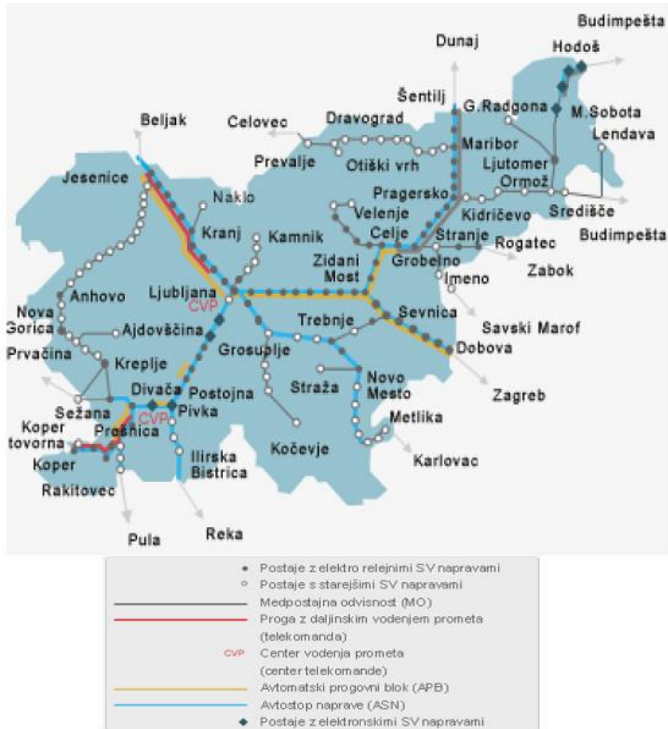
Slika 4: Karta opremljenosti prog SŽ s signalnovarnostnimi napravami (Vir: Slovenske železnice d.o.o. – Program omrežja RS 2009 – Priloga 3/9)
