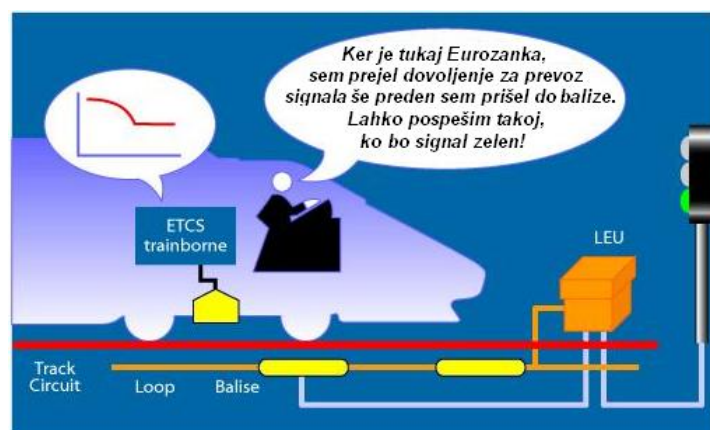
Slika 17: Sistem z izmenjavo podatkov z Eurobalizo (Vir: Spletna stran http://www.ertms.com/2007v2/what_levels.html )
