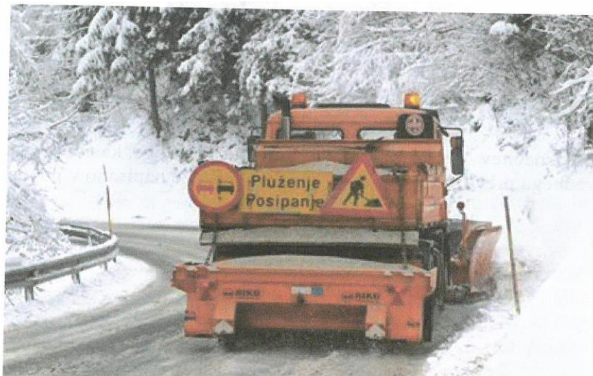
Slika 7: Označitev vozila »pluženje – posipanje« (Vir: Butala, Leskovar, Vrhovski, 2013)
