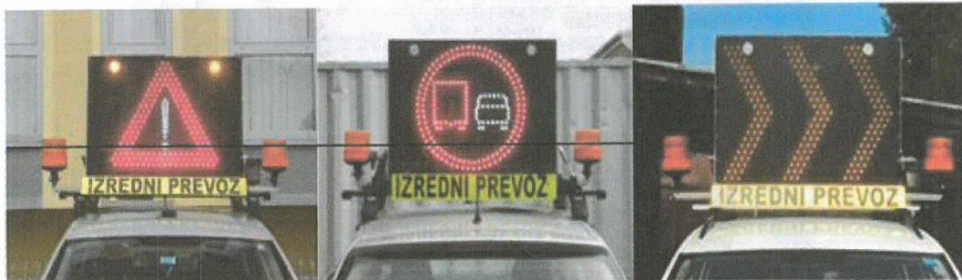
Slika 4: Dodatna oprema za zahtevno spremstvo (signalna tabla) (Vir: Butala, Leskovar, Vrhovski, 2013)
