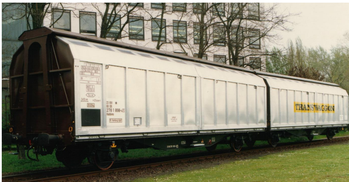
Slika 6: Hiirrs vagon 206 m 3 (Vir: Interna dokumentacija TRANSWAGGON 2009)
