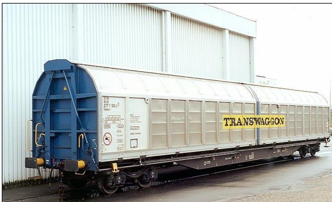
Slika 1: Habbiins vagon 167m 3 (Vir: Interna dokumentacija TRANSWAGGON 2009)
