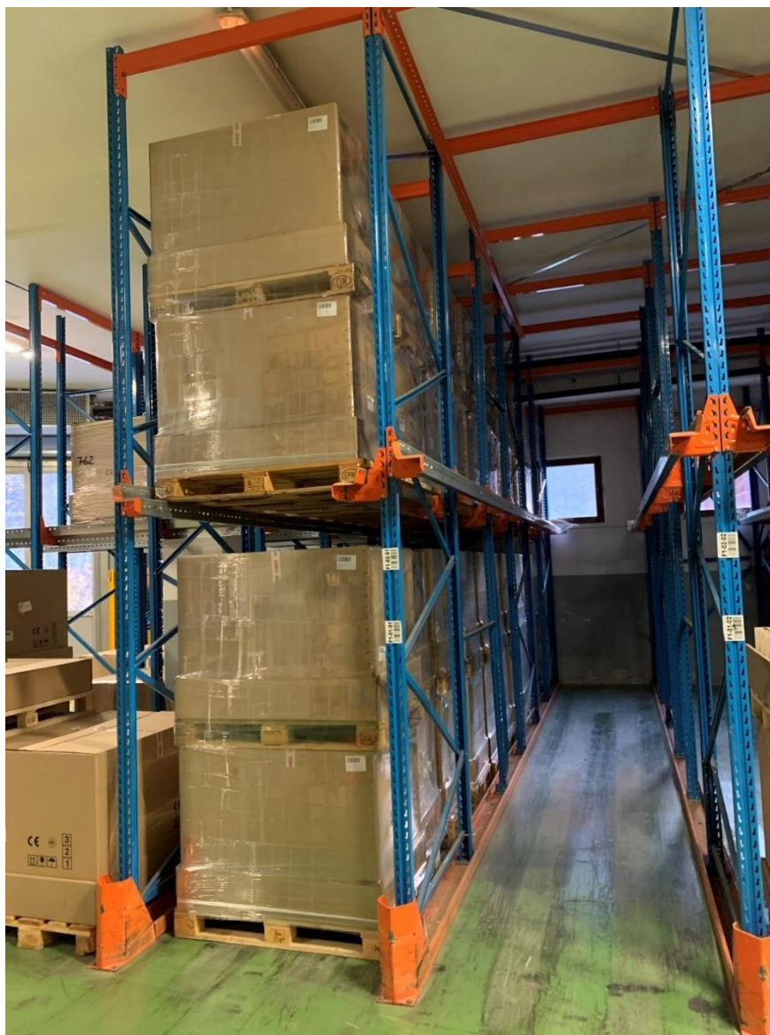
Slika 3: Stebrni regal LIFO v Domelu (Vir: Lasten)
