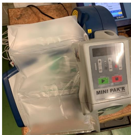
Slika 35: Naprava za zaščitni mehurčkast film Mini Pak'r (Vir: Lasten)
