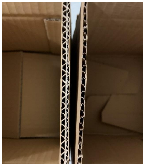
Slika 30: Enoslojna in dvoslojna lepenka (Vir: Lasten)
