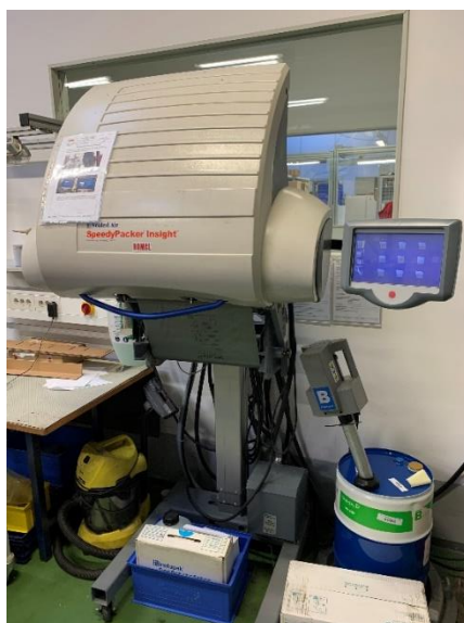
Slika 36: Naprava za zaščitno peno (Vir: Lasten)
