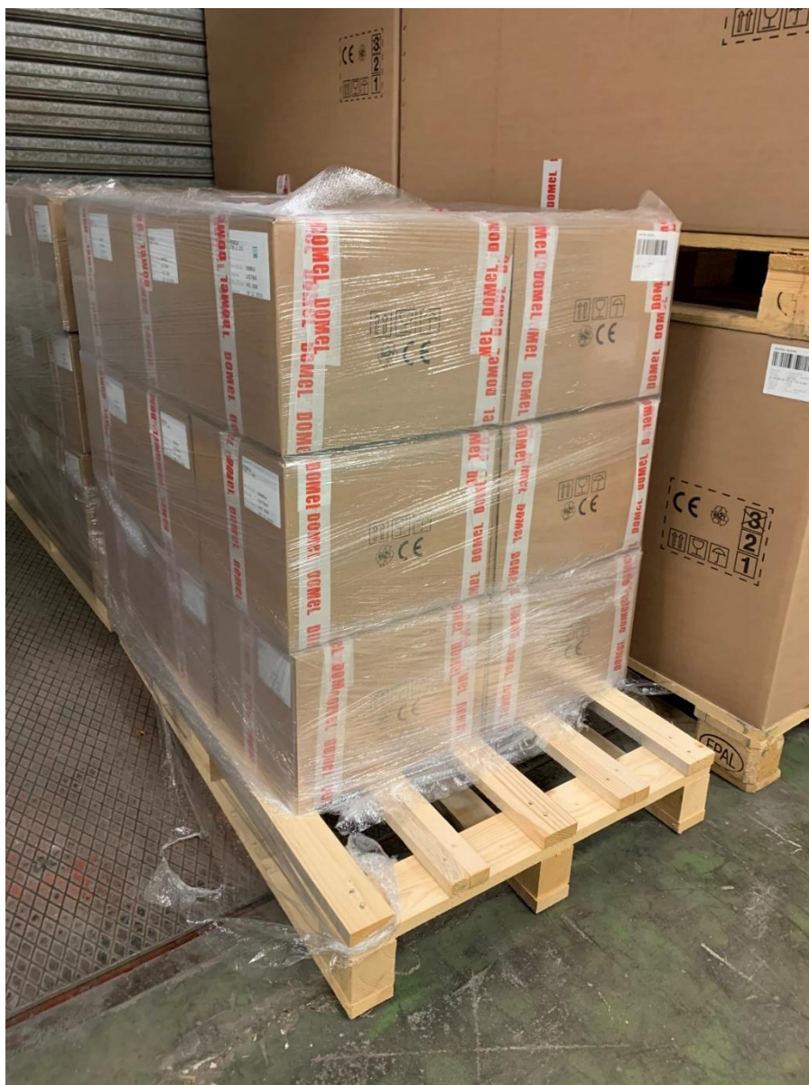
Slika 15: Paleta, slabo povita s streč folijo (Vir: Lasten)
