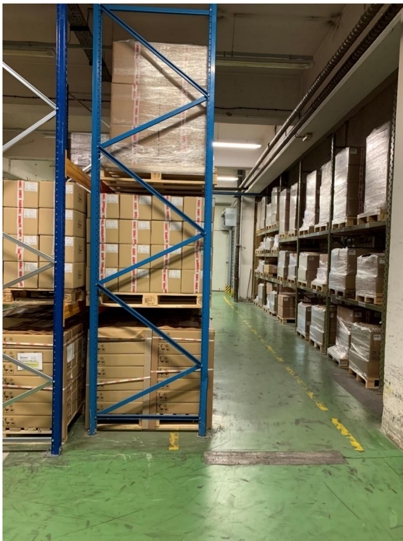
Slika 5: Enojna postavitev klasičnega regala desno in dvojna postavitev levo (Vir: Lasten)
