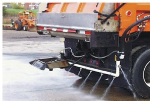
Slika 19: Šobe (a), ki razpršijo tekočino v obliki pahljače in šobe (b), ki razpršijo tekočino v obliki curka (Vir: Švegl, 2009)
