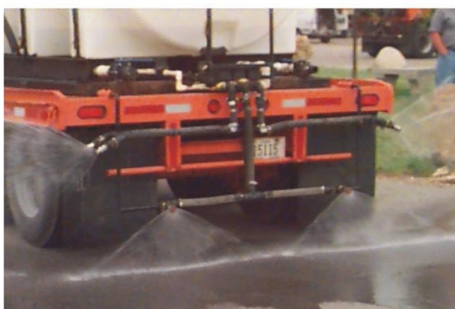
Slika 19: Šobe (a), ki razpršijo tekočino v obliki pahljače in šobe (b), ki razpršijo tekočino v obliki curka (Vir: Švegl, 2009)
