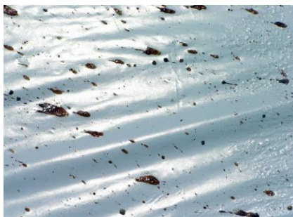
Slika 17: Izgled posipa pri razmerju 70 : 30, širini posipanja 4 m in količini posipa 10 g/cm 3 (Vir: Švegl, 2006)
