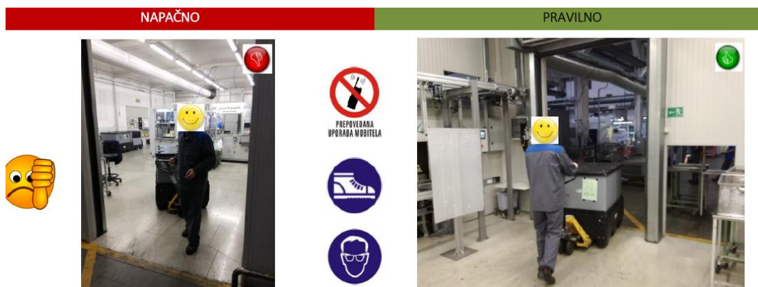
Slika 21: Navodila za varen transport bremen z ročnim paletnim viličarjem Vir: Interno gradivo podjetja X, 2016.
