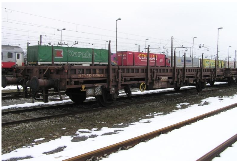
Slika 9: Navadni dvoosni plato vagon serije K-gs
