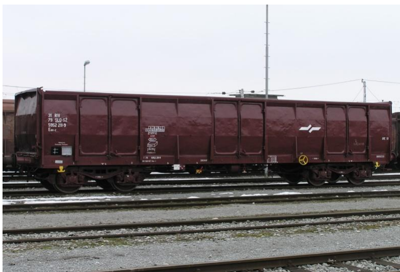
Slika 5: Navadni odprti vagon serije E-as
