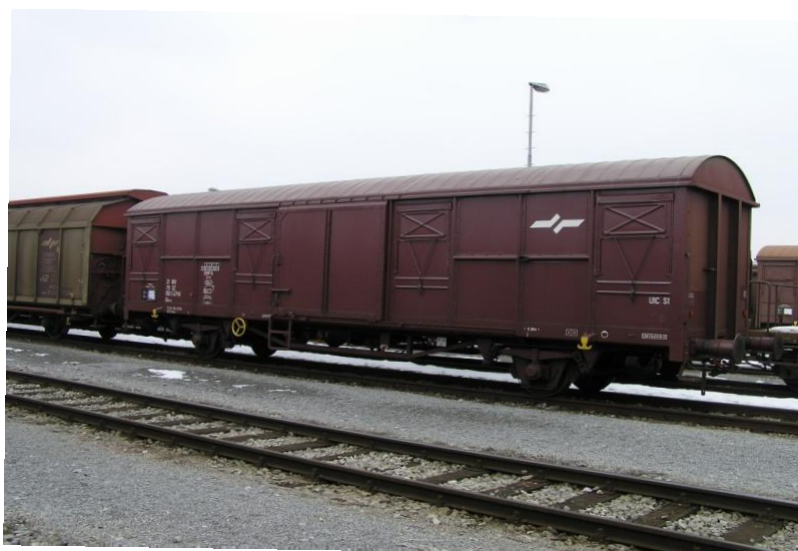
Slika 7: Navadni zaprti vagon serije G-bs
