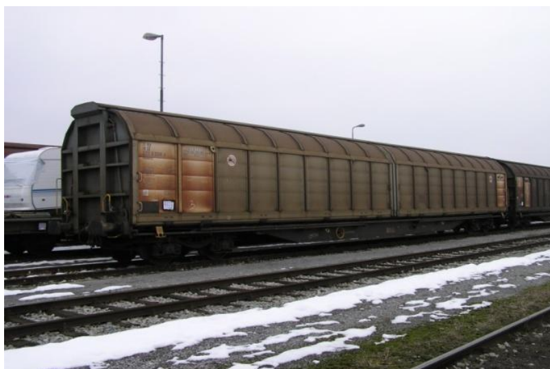
Slika 8: Specialni zaprti vagon serije H-abis
