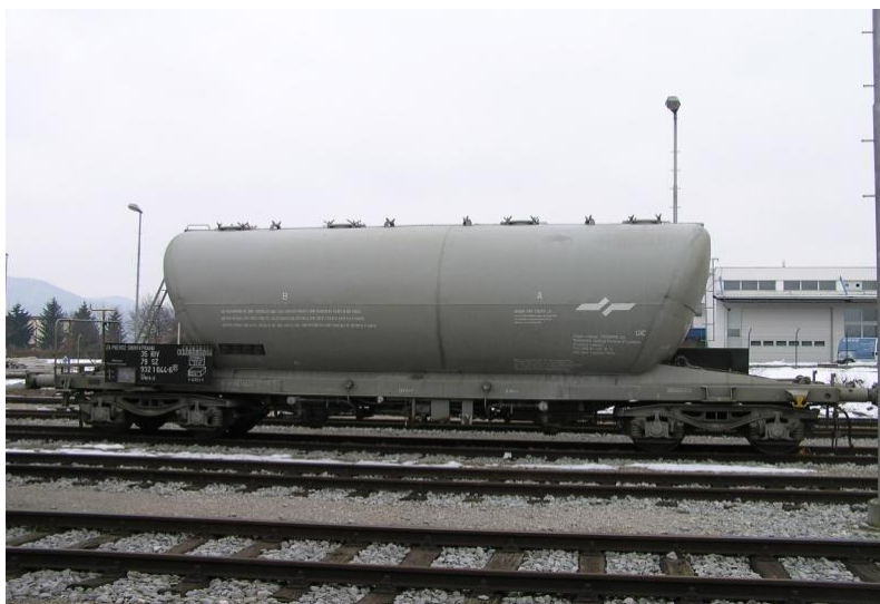
Slika 14: Specialni zaprt vagon serije U-acs
