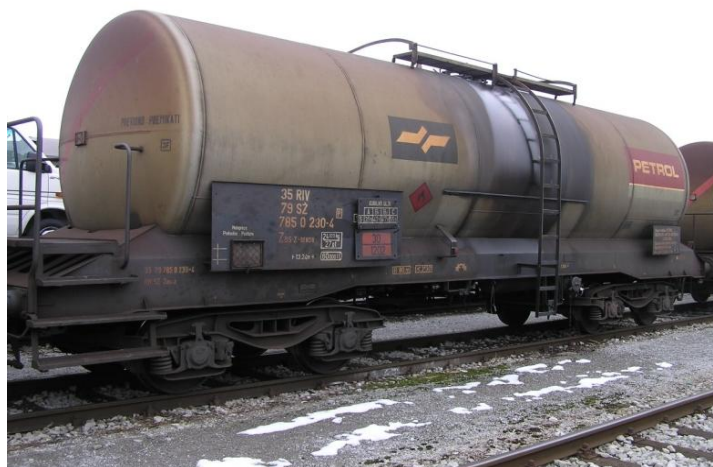
Slika 15: Specialni vagon – cisterna serije Z-as VIR: Simona Kosmač; 2008
