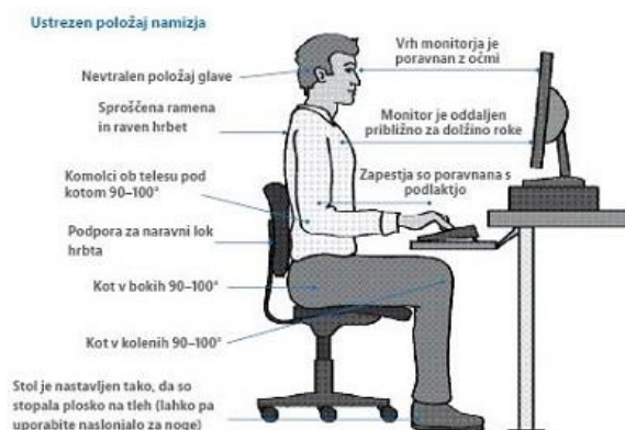
Slika 2: Priporočljive velikosti delovnega mesta z računalniškim zaslonom za optimalni telesni položaj pri delu
