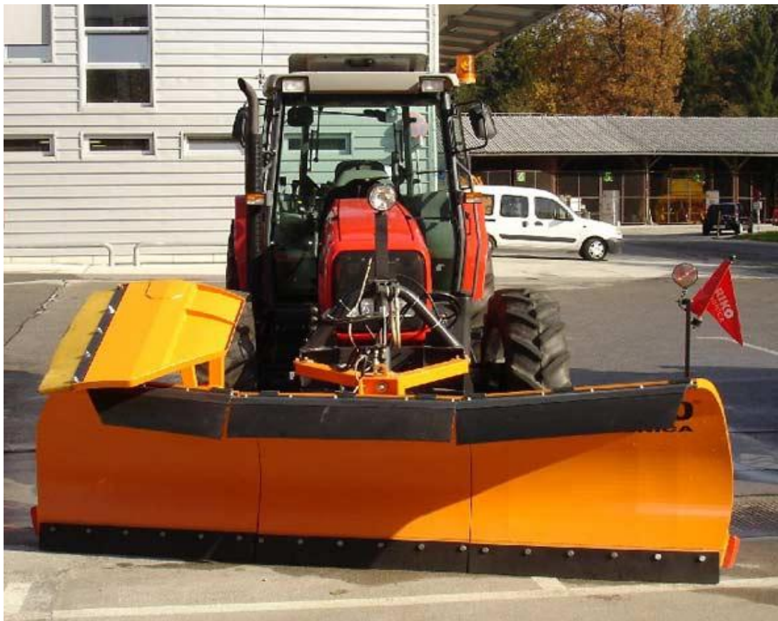
Slika 28: Delovne luči, nameščene nad plužno desko (vir: http://www.rikoribnica.com/slo/images/proizvodi/spg/plug-spg-04-v.jpg , 28.12.2008)
