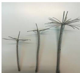
Slika 3 AL-FE goli vodniki, 25 , 35 , 70 \text{ mm}^2 Lastni vir
