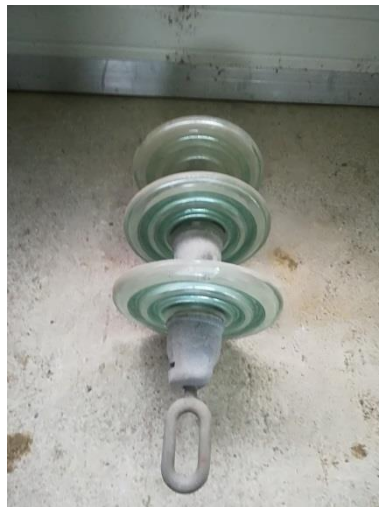
Slika 12 Steklena izolatorska veriga
