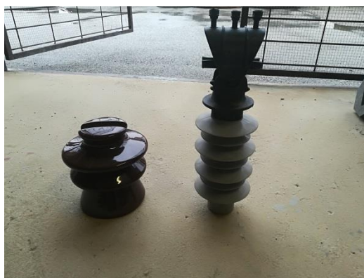
Slika 11 Porcelanasti in silikonski izolator
