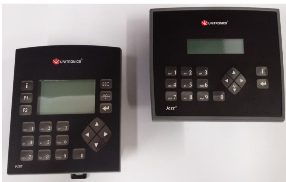
Slika 4: Primer krmilnih enot OPLC (Vir: lastni)
