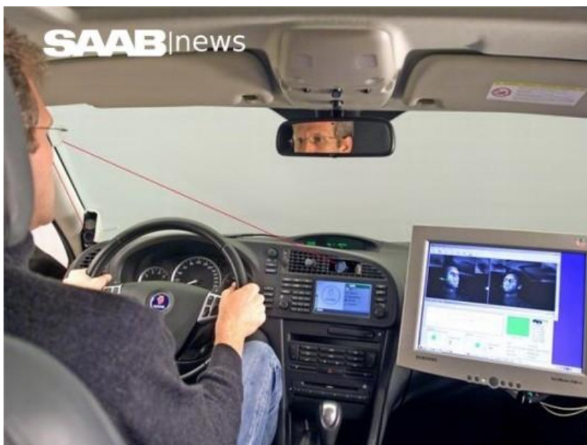
Slika 4: Saabov sistem za spremljanje voznikovih oči
