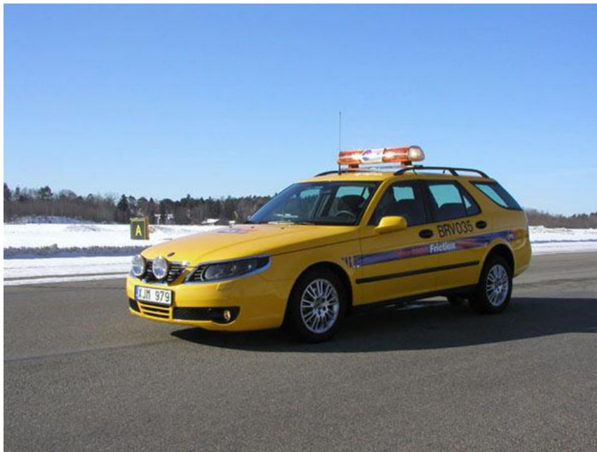
Slika 15: Merilec drsnosti SAAB (vir: http://www.airport-technology.com , 24. 8. 2009)
