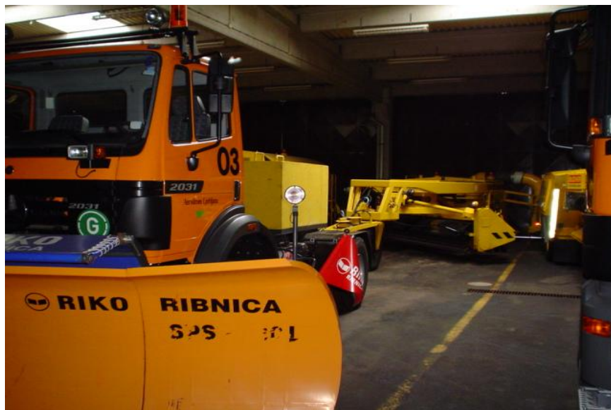
Slika 14: Tovornjak s plugom in krtačo (vir: Aerodrom Ljubljana, d.d.)
