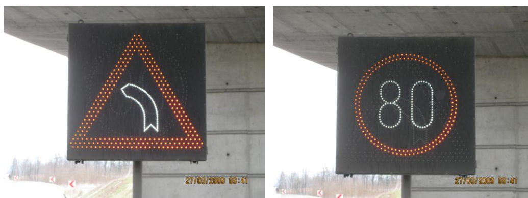
Slika 20: Primer za postavitev znaka spremenljivih vsebin
