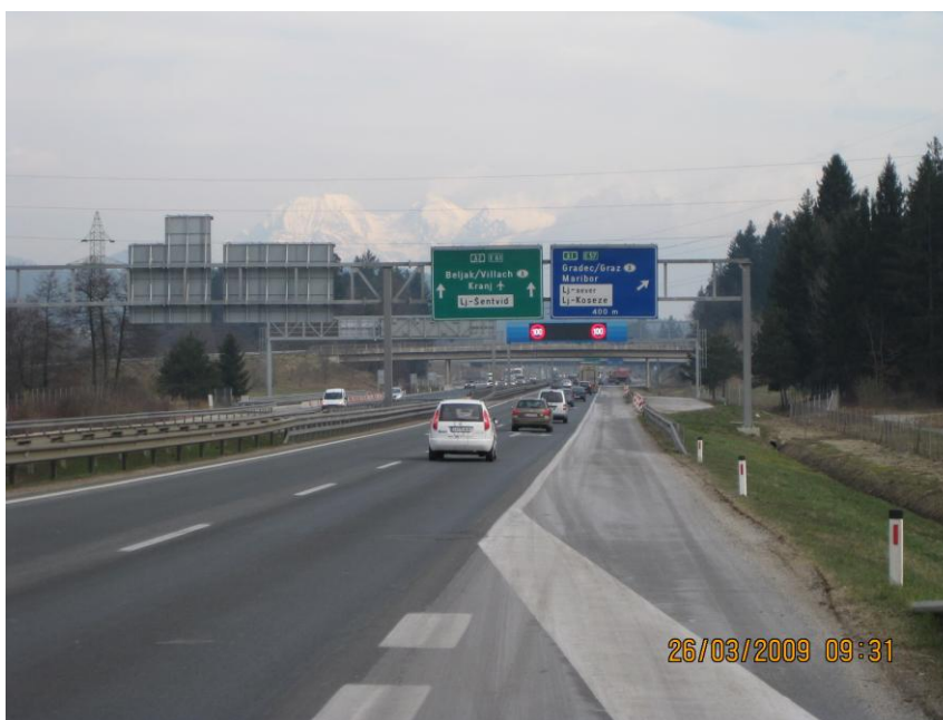
Slika 27: Sedanji odstavni pas, ki bi se ga spremenilo v tretjega oz. pomožnega
