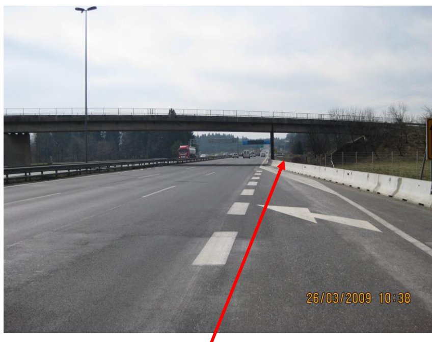
Slika 24: Mesto ukinitve pasu, zadaj za betonsko varovalno ograjo bi bilo potrebno namestiti znak III – 107.2 tablo za usmerjanje
