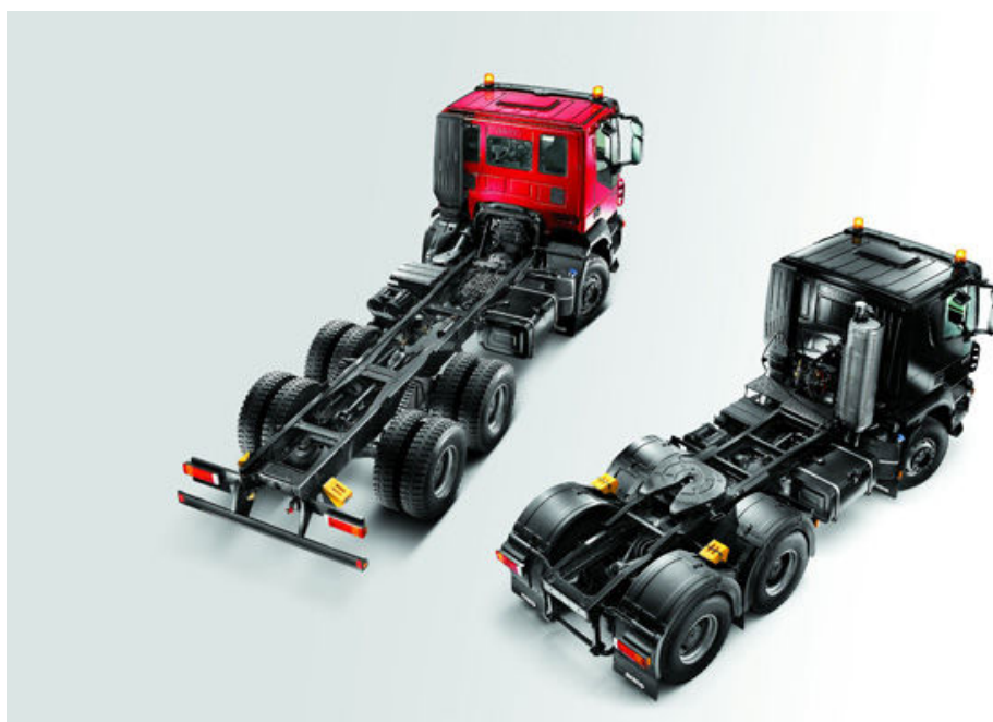
Slika 14: Iveco TRAKKER AD 6 x 4 (šasija) in TRAKKER AT 6 x 4 (vlačilec) (Vir: www.iveco.com )
