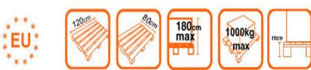
Slika 6: Dimenzije euro palete, maksimalna višina in nosilnost
