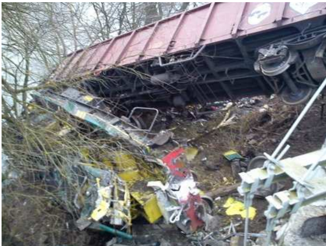
Slika 8 Škoda, nastala pri iztirjenju (Vir: lasten)
