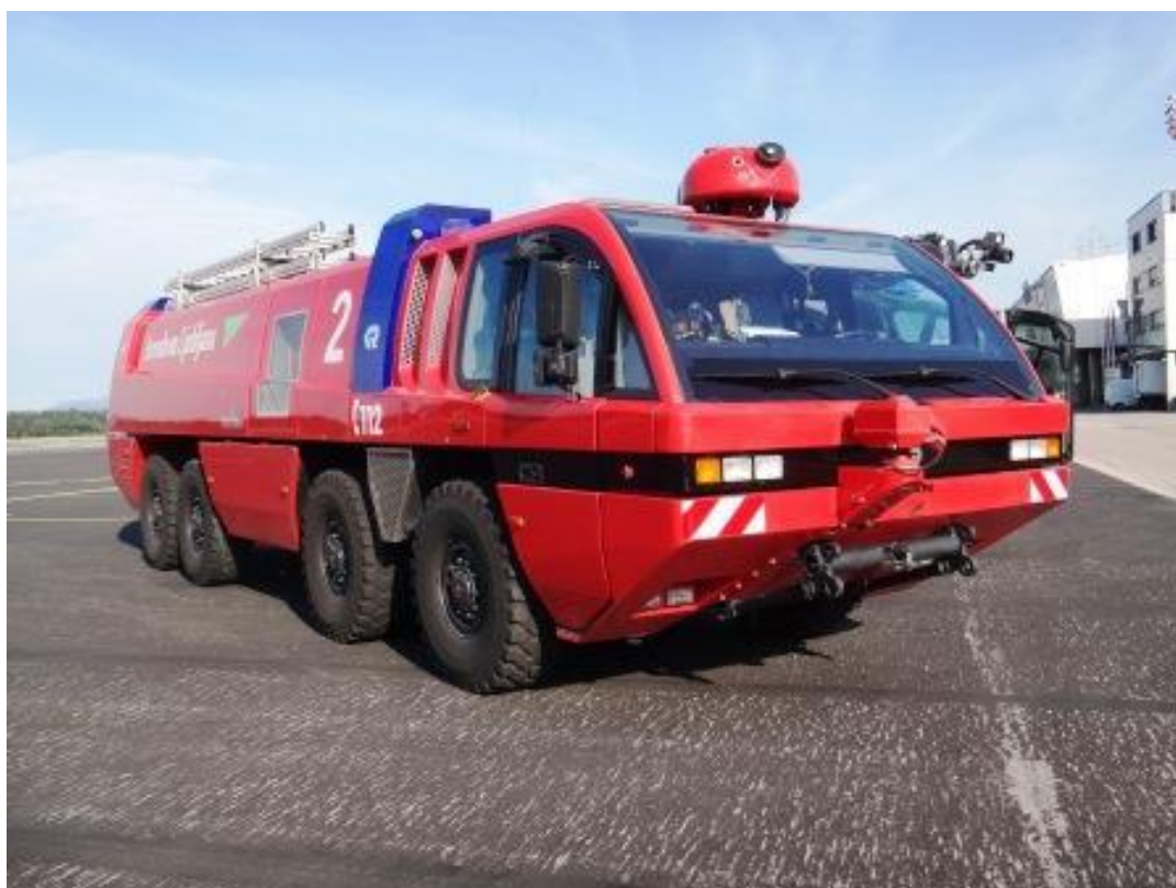
Slika 12: Gasilsko vozilo za hitro posredovanje Rosenbauer PANTHER 8x8 (Lastni vir, 2015)
