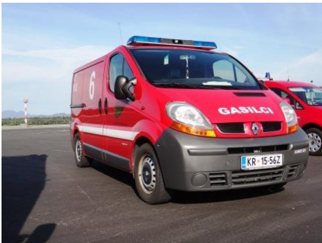
Slika 11: Manjše gasilsko vozilo z vodo Renault TRAFIC 4x2 (Lastni vir, 2015)
