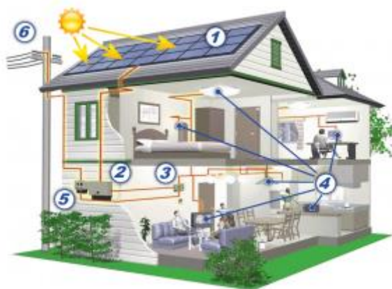
Slika 23: Objekt in prikaz delov male sončne elektrarne
