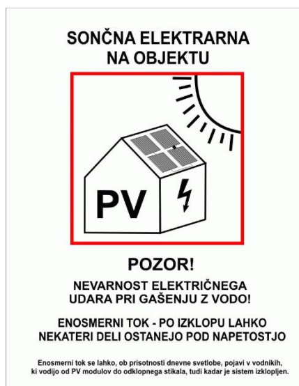
Slika 14: Oznaka na objektu, kjer je vgrajena sončna elektrarna (Vir: lasten)
