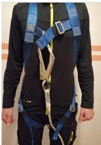
Slika 19: Pravilna namestitve varnostnega pasu (Vir: lasten)
