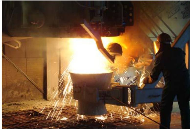
Slika 2: Spodnji del kupolne peči (izpust železa)
