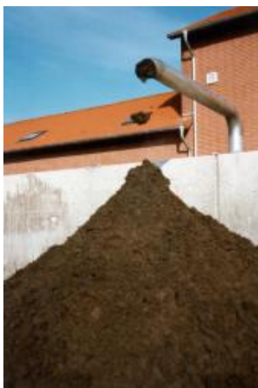
Slika 4: Prečrpavanje blata iz komunalne čistilne naprave
