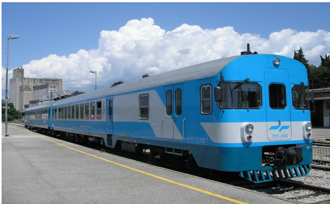
Slika 3: Dizelska hidravlična motorna garniture serije 711 – zunanost (Vir: Slovenske železnice, d. o. o.)
