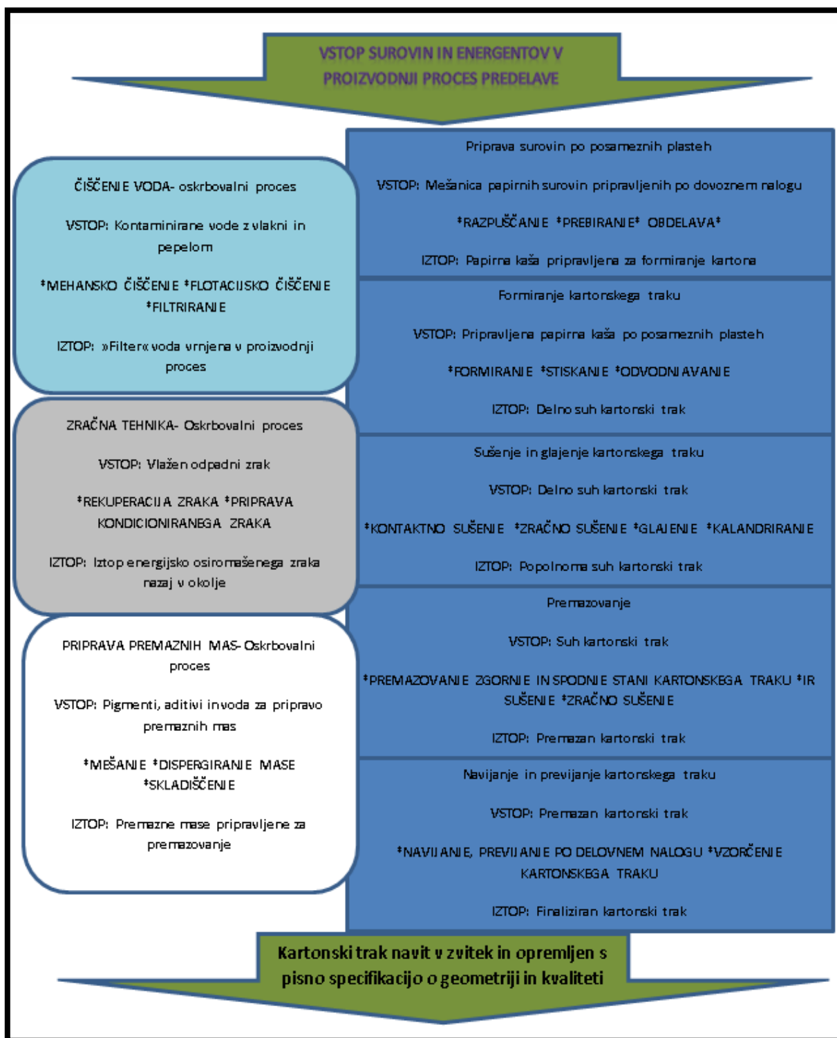
Slika 1: Shema izdelave kartonskega traku (Vir: Interni, Količevo Karton d.o.o., 2013)
