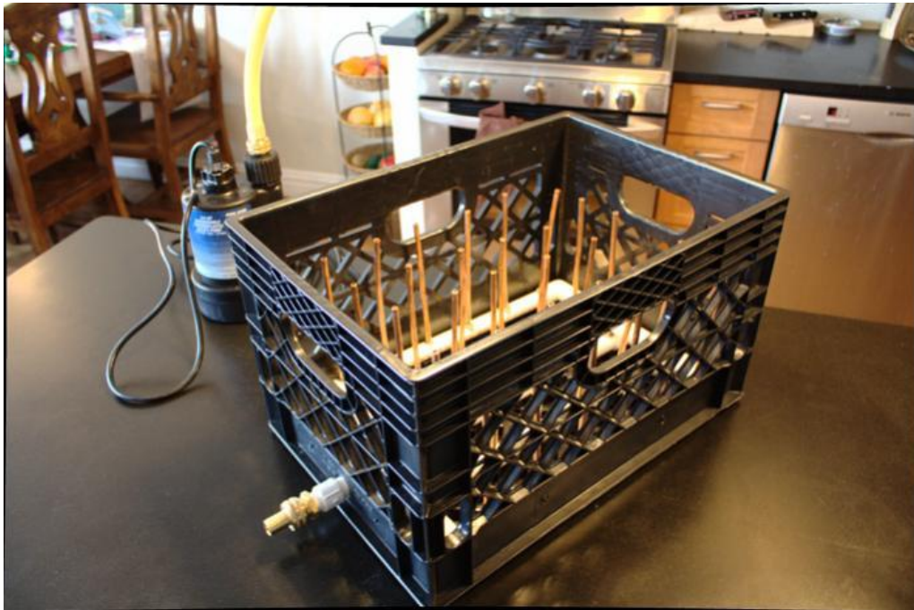
Slika 6: Domača naprave za čiščenje steklenic (Vir: Homebrew Talk, 2013)
