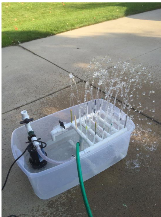
Slika 5: Naprava iz PVC-ja za čiščenje steklenic (Vir: Instructables, 2016)
