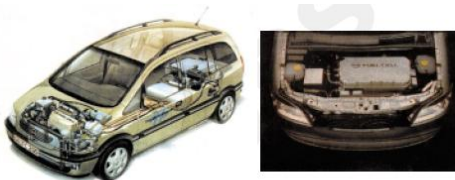
Slika 23: Gorivna celica v avtomobilu (Energija in okolje, 2000)
