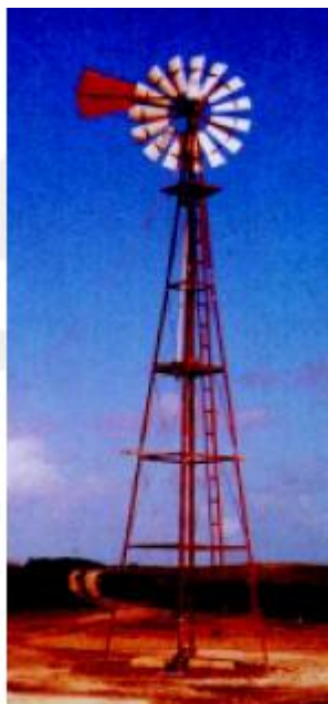
Slika 12: Tipična večlistna počasna vetrnica za črpanje vode (Varstvo okolja in obnovljivi viri energije, 2000)
