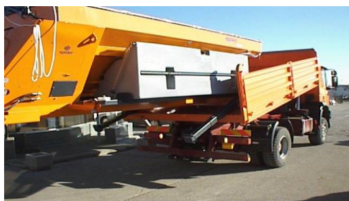
Fotografija 18 in 19: Proces nalaganja posipalnika na keson vozila Vir: Lastni
