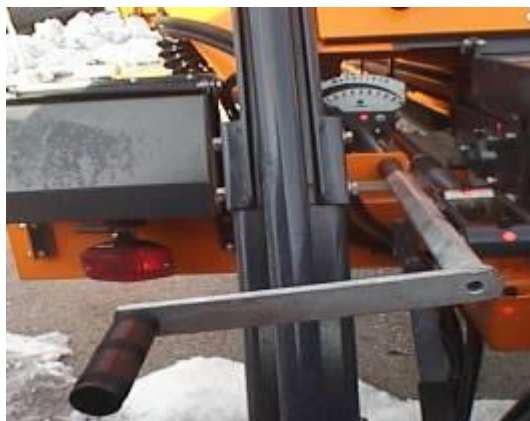
Fotografija 17: Primer kalibracije silosnega posipalnika: polnitev zagon, izhod materiala, zajem materiala v vrečo, tehtanje
