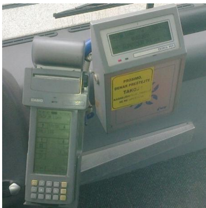
Slika 4: AFC-strojček in čitalec brezkontaktnih čip vozovnic (Vir: Lasten)
