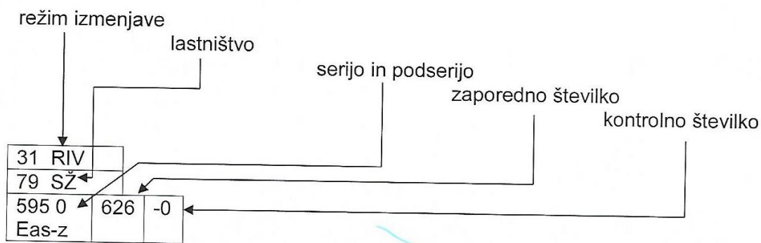
Slika 8: Pomen dvanajstmestne številke na vagonu (Vir: Učni pripomoček za interno uporabo, 2008)
