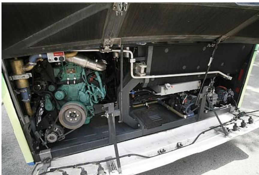
Slika 21: Motor hibridnega avtobusa Vanhool
