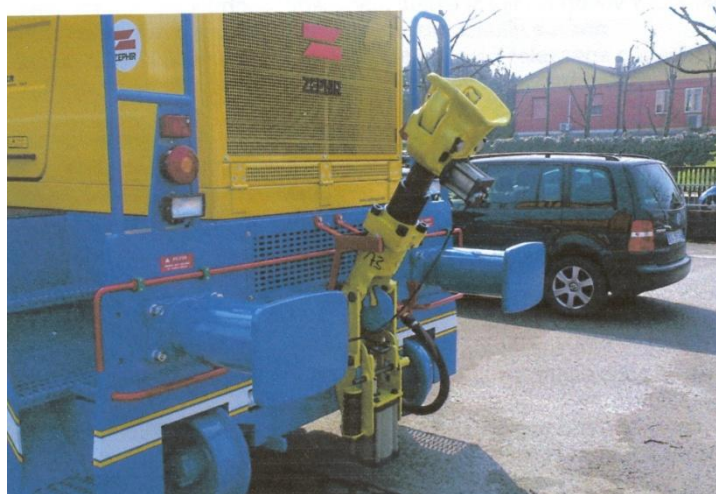
Slika5: Avtomatiziran sistem spenjanja vagonov na novem vozilu Zephir
