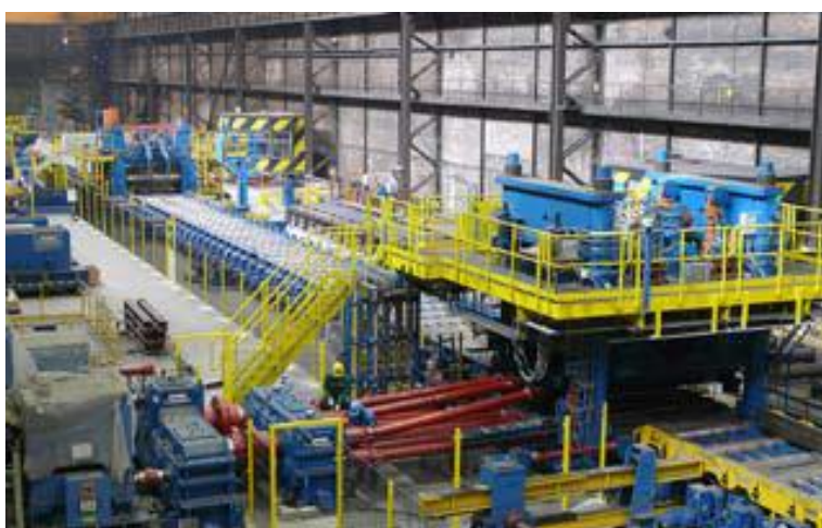
Slika 9: Vroči razrez plošč ob koncu procesa valjanja
