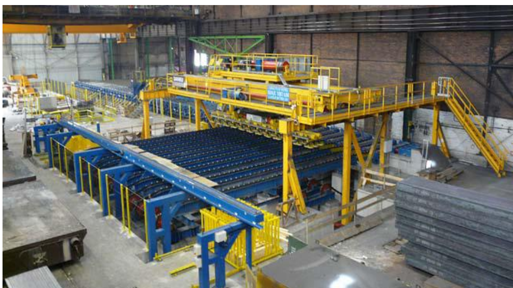
Slika 10: Tračni in žerjavni manipulator plošč Vir: Interni mesečni bilten Sij, d. d., marec 2010
