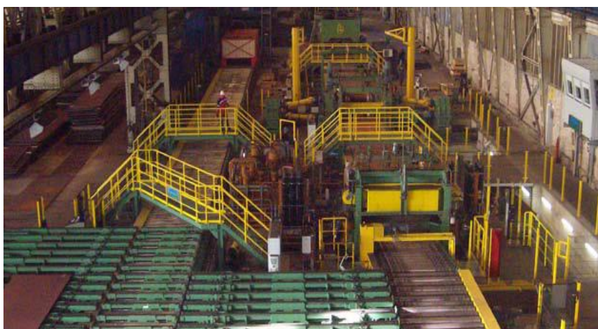
Slika 14: Transportno-razrezna linija Sundwig za razrez debele pločevine Vir: Interni mesečni bilten Sij, d. d., marec 2010
