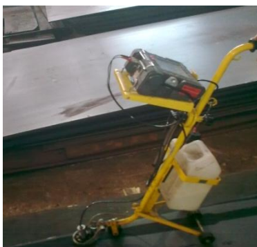
Slika 12: Ultrazvok za ugotavljanje procesnih napak v materialu Vir: Igor Triplat Bunjevac, marec 2010
