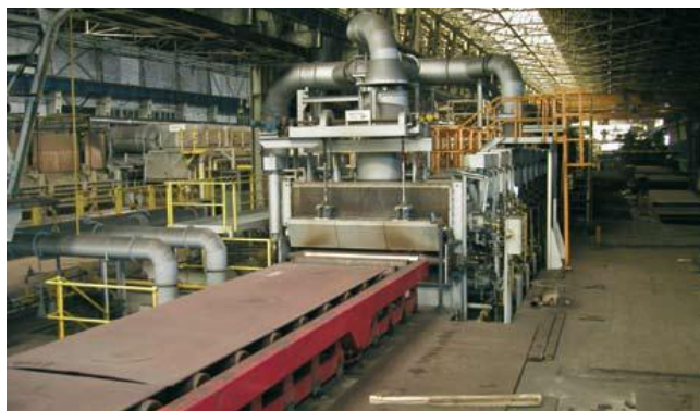
Slika 13: Toplotni liniji Wellman-Drever in Wellman-Wellman v ozadju Vir: Igor Triplat Bunjevac, marec 2010
