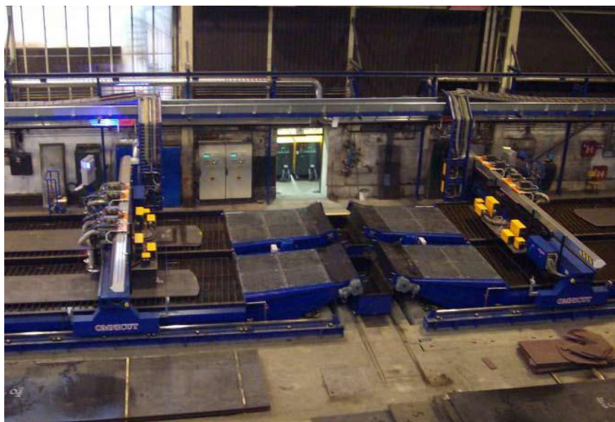
Slika 15: Plazemska CNC rezalnica z odlagalnimi mesti Vir: Igor Triplat Bunjevac, marec 2010
