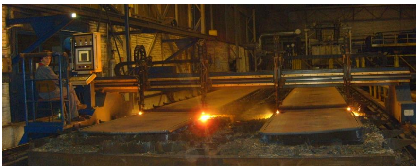
Slika 11: Razrez navadne pločevine na plamenskih CNC rezalnikih Vir: Igor Triplat Bunjevac marec 2010
