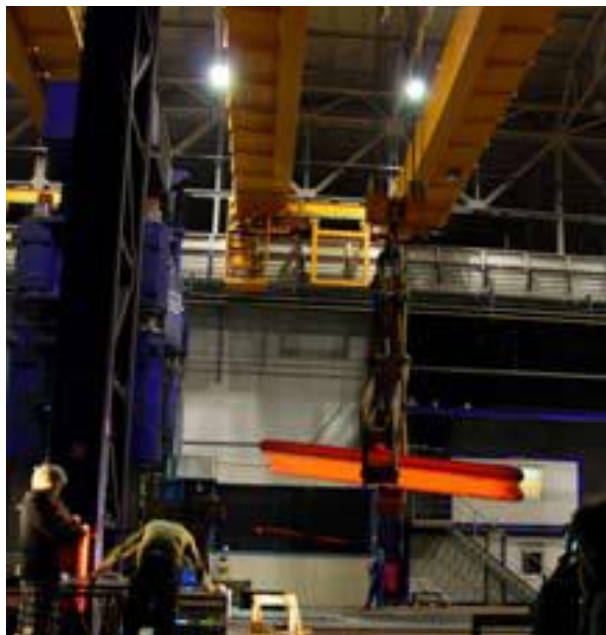
Slika 7: Naklad slabov z mostnim žerjavom na livne vozove Vir: Interni mesečni bilten Sij, d. d., marec 2010
