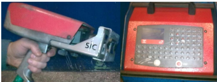
Slika 20: Gravirna naprava z označevalno-nerično konzolo
